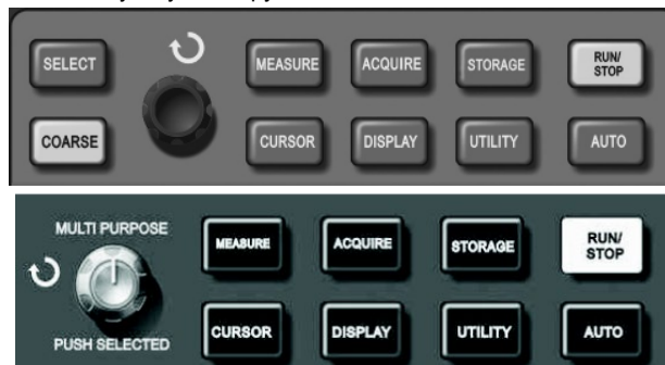
Рисунок 2-29. Функциональная кнопка автоматических измерений (MEASURE) в системе выборки данных
