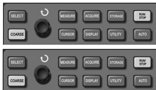
Рисунок 2-28. Функциональная кнопка вызова вспомогательных функций (UTILITY) в системе выборки данных
