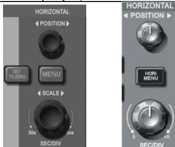
Рисунок 2-11. Интерфейс системы горизонтальной развертки
