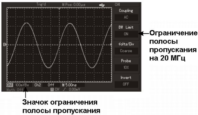
Рисунок 2-5. Вид дисплея при ограничении полосы пропускания
