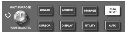
Рисунок 2-23. Функциональная кнопка запоминания (STORAGE) в системе выбора данных
