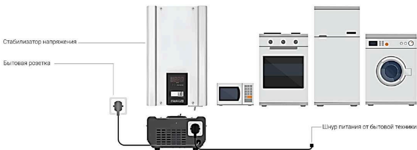
Рисунок 13. Подключение стабилизатора к сети
