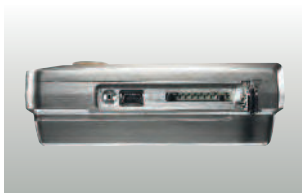
Разъем для подключения Мини-USB кабеля или SD-карты
